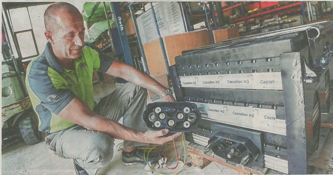
Hans-Georg Castellan hat ein System erfunden, das elektrischen Lastwagen theoretisch unbegrenzte Reichweite ermöglicht. Die Fahrer tauschen einfach die Batterie aus und können ihre Fahrt fortsetzen.
